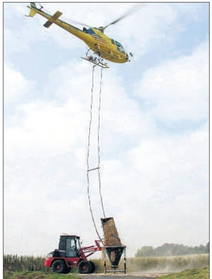
Nachschub holen: Ein Mitarbeiter kippt mit einem Radlader Kalk in den Behälter, der mit Trossen am Helikopter befestigt ist.
