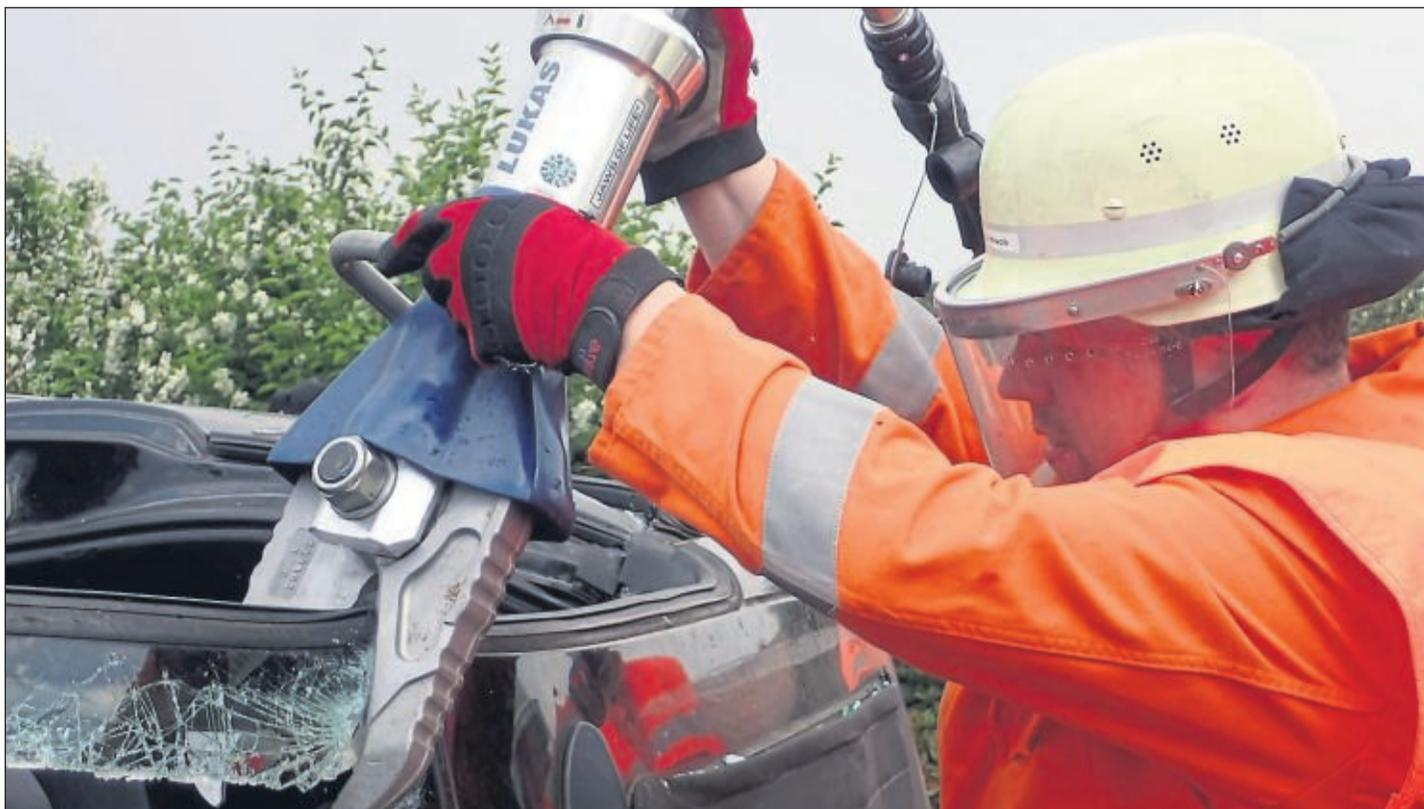
Hydraulisches Gerät: Mit dem Spreizer drückte ein Feuerwehrmann bei der Schauübung am Feuerwehrtag in Benterode die Holme eines Autos weg.
